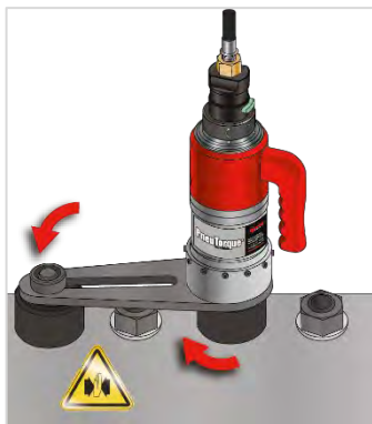
FIGURA 7 – Esempio di reazione in senso orario (FWD)
