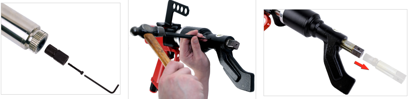
FIGURE 9 – Remplacement du carré d'entraînement
