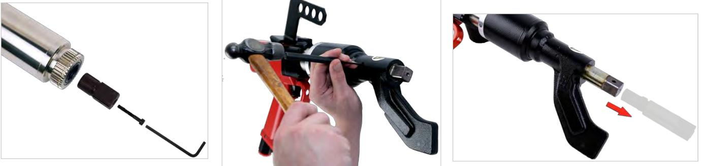
**ILUSTRACIÓN 11 – Sustitución Del Cuadro Transmisor**
