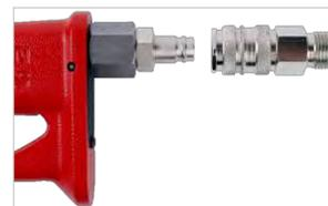
Conecte la entrada de la unidad de control Lubro (Ilustración 1-B) al suministro principal de aire (Ilustración 1-A) utilizando un manguito de ½ pulgada de calibre (12 mm) como mínimo. Evite utilizar manguitos de ½ pulgada de calibre con un largo mayor a 5 metros desde el suministro hasta la unidad reguladora de presión, ya que esto reduciría el rendimiento de la herramienta.
