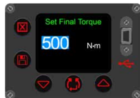
FIGUR 26 – Indstil mål for endeligt drejningsmoment
