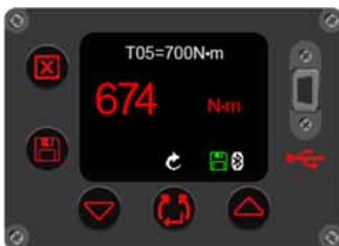
FIGUR 52 – Resultat for dreiemomentmål (vist i rødt for svikt)
