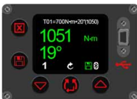
FIGUR 53 – Resultat for dreiemoment- og vinkelmål (vist i grønt for passert)
