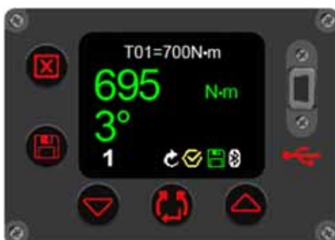
FIGUR 54 – Resultat for audit dreiemomentmål (viser oppnådd dreiemoment og utgang (bolt) bevegelse i grader)
