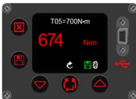
RYSUNEK 52 – Wartości docelowe momentu obrotowego (przedstawione w kolorze czerwonym oznaczającym nieprawidłową wartość)
