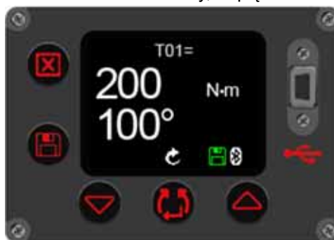
RYSUNEK 19 – Wartość docelowa momentu obrotowego i kąta obrotu
