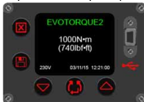
RYSUNEK 43 – Wyświetlenie parametrów Tool Capacity (Znamionowy moment obrotowy narzędzia), Voltage (Napięcie), Date/Time (Data/czas).
