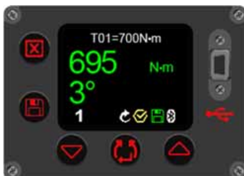
RYSUNEK 54 – Wynik docelowy kontroli momentu dokręcania (wyświetlana jest zmierzona wartość i obrót śruby w stopniach).
