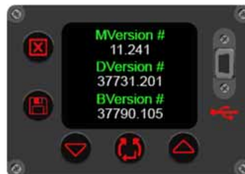
RYSUNEK 45 – Widok numerów wersji oprogramowania silnika/wyświetlacza
