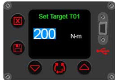
RYSUNEK 24 – Wstawiona wartość docelowa momentu obrotowego dokręcania
