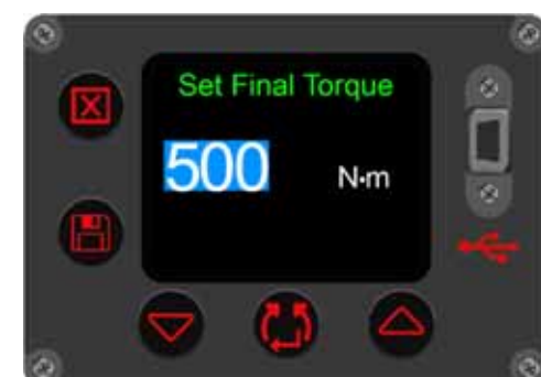
RYSUNEK 26 – ustawiona wartość końcowego momentu dokręcania.
