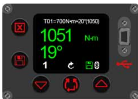
RYSUNEK 53 – Wartości docelowe momentu dokręcania i kąta (z końcowym momentem dokręcania) przedstawione w kolorze zielonym oznaczającym prawidłowe wartości.
