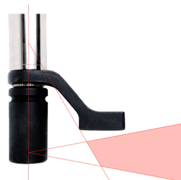
FIGUUR 4 – veilig reactievenster voor extra lange socket
