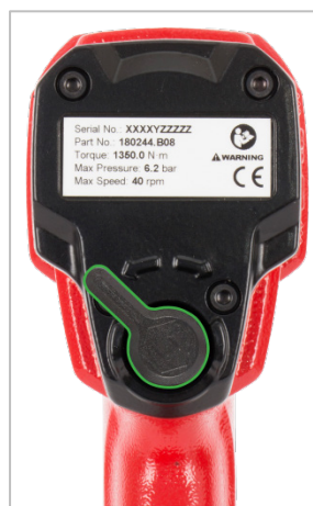
FIGUUR 7(b) – tegen de klok in (Hendel wijst naar links)
