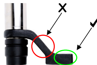
FIGUUR 2 – gebogen reactiebalk (staal of aluminium)
