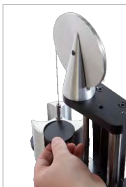
FIGUR 17 – Tilføjelse Af Vægte Til Modbalancereaktions-Samlingen
