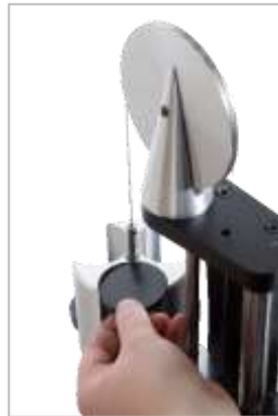
FIGURE 17 -Ajout de poids à l'ensemble de réaction et de contrepoids
