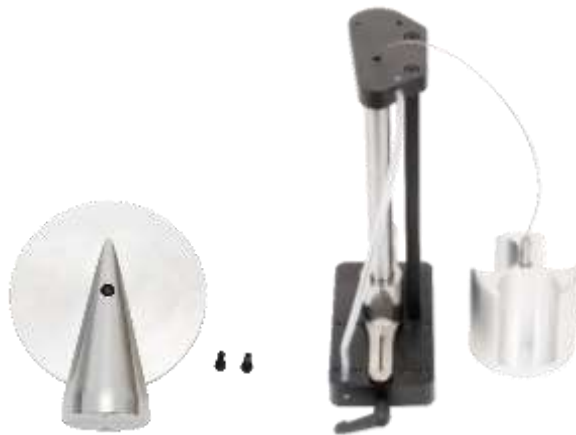
FIGURE 8 – Colonne de réaction et de contreponds démontée
