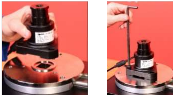
FIGURE 14 - Pose d'une sonde FMT
