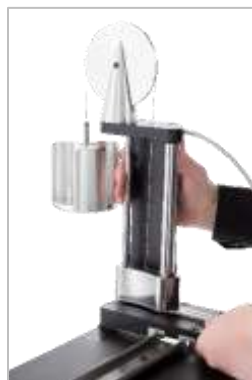
FIGURE 12 - Glisser l'ensemble de réaction et de contrepoids sur le rail de réaction
