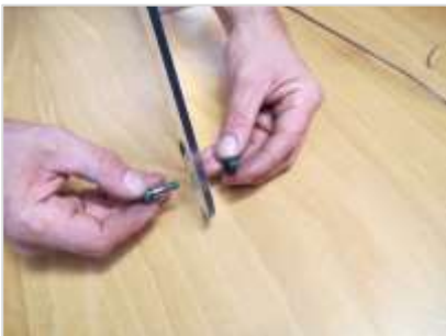
FIGURE 6 - Appariement des rondelles en néoprène avec les boulons à épaulement
