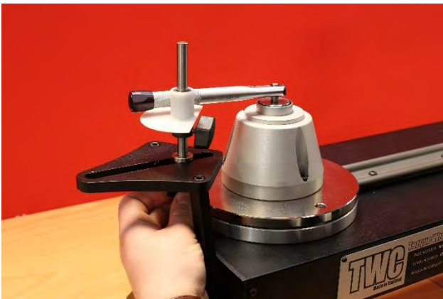
FIGUR 29 – Justere Reaksjonspunkt For Korte Reaksjonsplater
