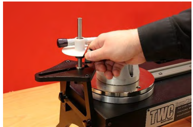
FIGUR 29 – Justere Reaksjonspunkt For Korte Reaksjonsplater
