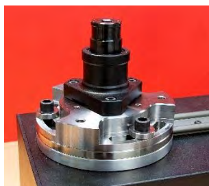
FIGUR 32 – Feste TWC Vinkelforskyvningsplate
