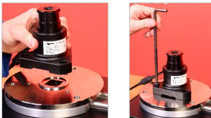
FIGUR 14 - Feste Av En FMT-Transduser
