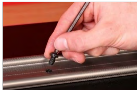
RYC. 21 — Wykręcanie Śruby Z Łbem Półkulistym
