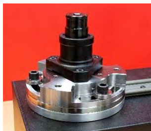
RYC. 32 — Przytwierdzanie Płytki Odchylenia Kątowego TWC
