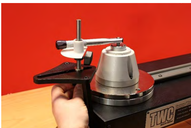
RYC. 29 — Regulacja Punktu Reakcji Krótkiej Płytki Reakcyjnej
