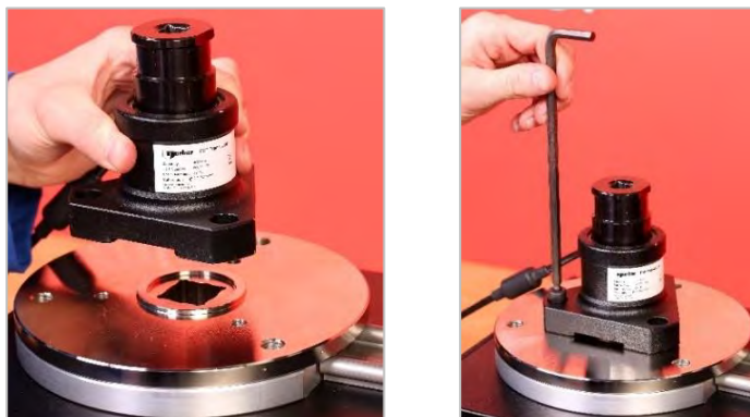
RYC. 14 — Montowanie Przetwornika FMT Z Kołnierzem Mocującym
