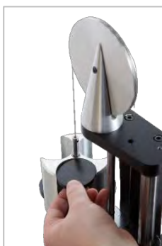
RYC. 17 — Dodawanie Obciążników Do Zespołu Reakcyjnego Przeciwwagi
