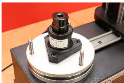
RYC. 31 — Mocowanie Zestawu Szybkiego Zwalniania FMT
