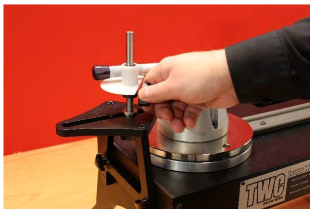
RYC. 29 — Regulacja Punktu Reakcji Krótkiej Płytki Reakcyjnej
