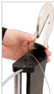
RYC. 9 — Ustawianie Koła Reakcyjnego Przeciwwagi
