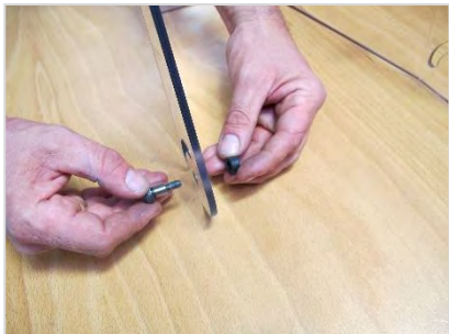
RYC. 6 — Zakładanie Neoprenowych Podkładek Na Śruby Z Niepełnym Gwintem
