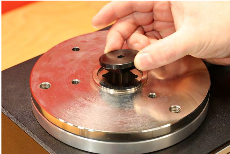
RYC. 26 — Zakładanie Kwadratowego Adaptera
