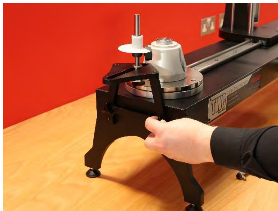
RYC. 28 — Przytwierdzanie Krótkiej Płytki Reakcyjnej
