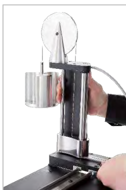
RYC. 12 — Wsuwanie Zespołu Reakcyjnego Z Przeciwwagą Na Szynę Reakcyjną
