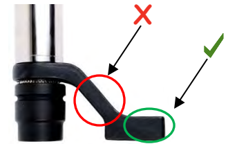
KUVA 6 – Taivutettu vastavoimavarsi (teräs tai alumiini)
